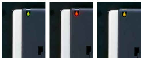
▲緑色点灯 (解錠表示) ▲赤色点灯 (エラー表示) ▲橙色点滅 (スマートフォン通信中)
