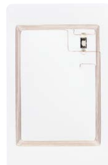
カード内部構造 (IC)
