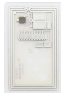
カード内部構造 (IC)
